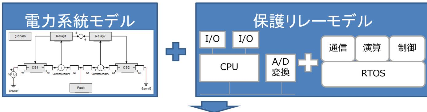
二つのモデルを構築して協調シミュレーションによる制御処理の検証を行い、検証結果と過去データとの比較から各モデルの再現性、保護リレー開発における有効性を調査
